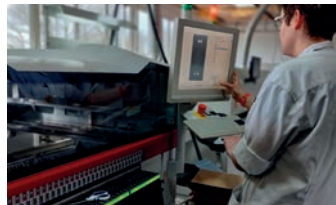
Machine de placement à barillet rotatif acquise en 2019.
